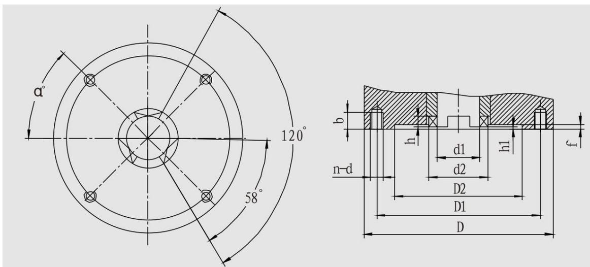
转矩型（三爪）连接尺寸图（JB 2920-81）
